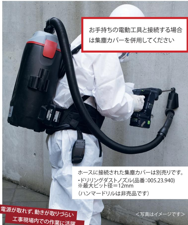
お手持ちの電動工具と接続する場合は集塵カバーを併用してください
